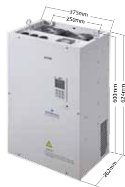
37kW ~ 55kW 重量: 35/38kg 安装孔径: 9mm
